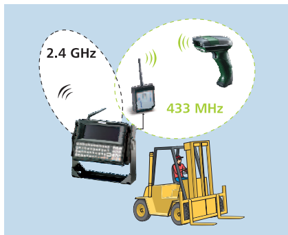
Gabelstapler-Terminals mit Datalogic RF-Lesern
